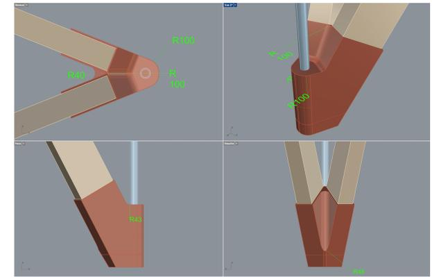
Détail socle béton
