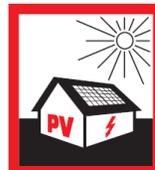
Cette plaquette signalétique doit être apposée près du coupe-surintensité pour raccordement, ainsi que près de l'ensemble d'appareillages, entre le coupe-surintensité pour raccordement et l/les onduleur(s). Elle doit être apposée bien visiblement à l'extérieur près de l'ensemble d'appareillages
