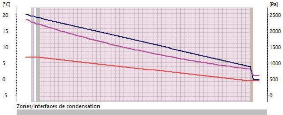
■ Pression de vapeur d'eau [Pa]      ■ Press. de saturation [Pa]      ■ Température [°C]
