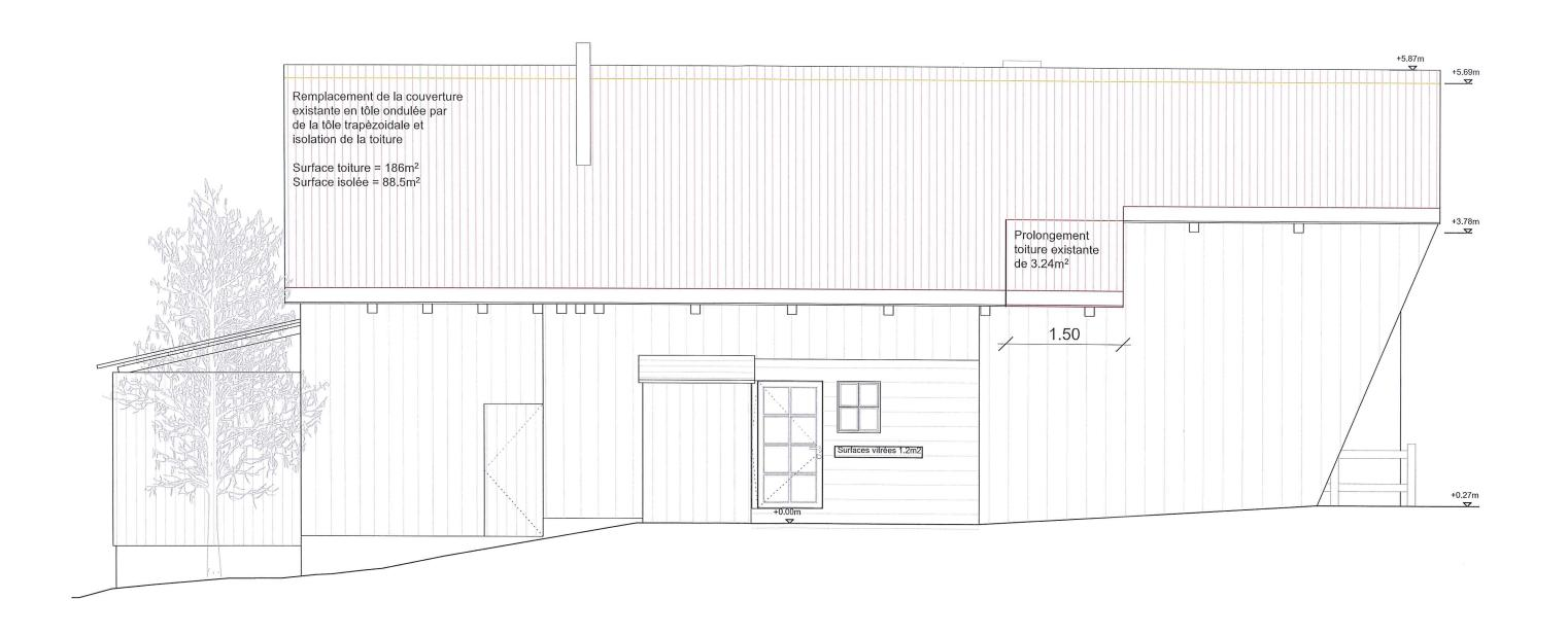
**Projet:** Changement de couverture de toiture, isolation toiture, sondes géothermiques et installation solaire thermique et mise en conformité d'un panneau solaire photovoltaique en façade sud.
