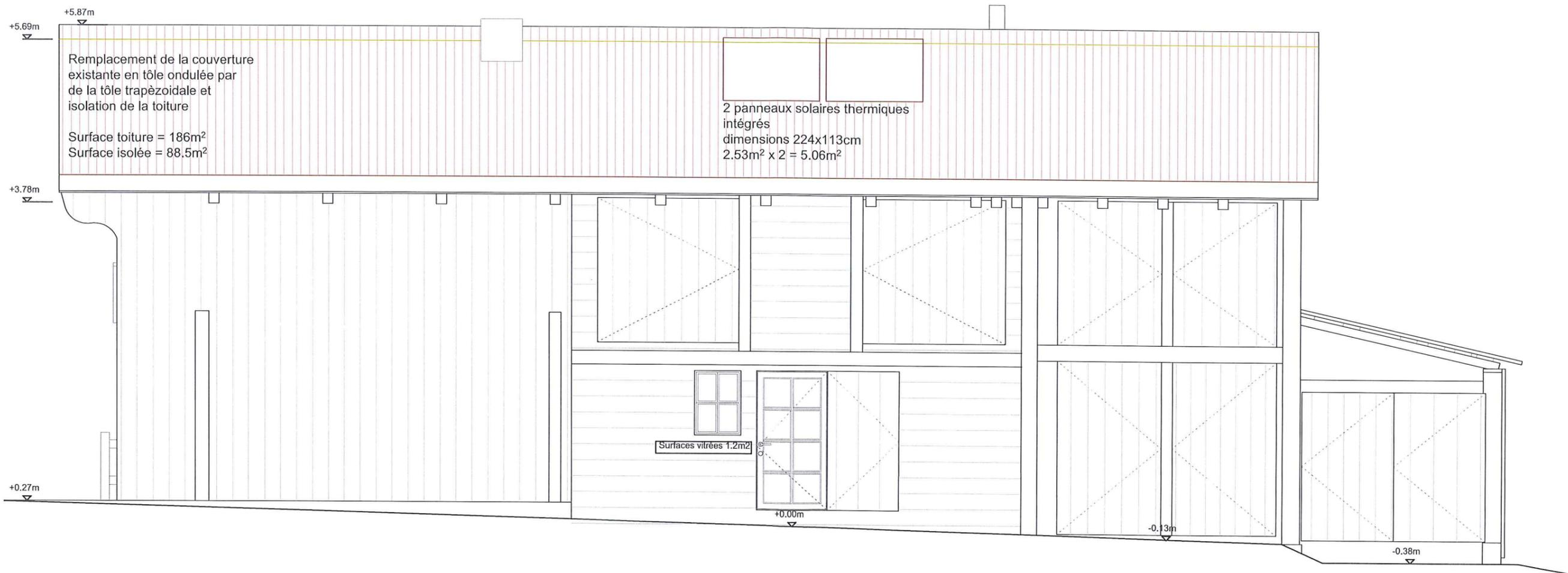
**Projet:** Changement de couverture de toiture, isolation toiture, sondes géothermiques et installation solaire thermique et mise en conformité d'un panneau solaire photovoltaïque en façade sud.
